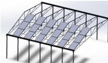
Disposición lateralmente abierta de los módulos en cada lado - figura superior-; vista inferior de dicha configuración (abajo)
